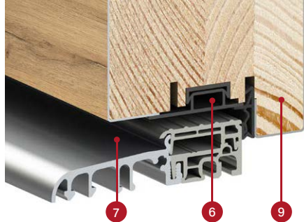
THERMO 78 ajtószárny keresztmetszete takaró tömítéssel és anélkül, alumínium küszöb
